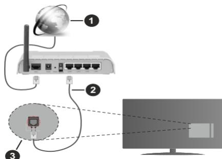
1. Conexión ISP de banda ancha
